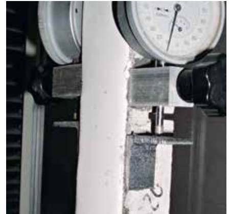
EN 1062-7 (Metod B) standardına göre dinamik çatlak köprüleme deneyi
