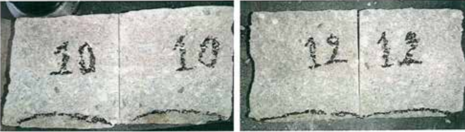
Resim 6. MasterLife WP 1200 Katkılı Numune Havada Kür (sol,) Suda Kür (sağ)
