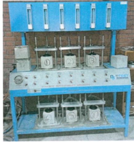
Resim 3. Basınçlı Su Deney Düzenegi
