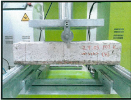
Resim 7. Kontrollü Çatlak Oluşturulması
