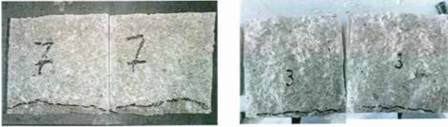
Resim 5. MasterLife WP 3760 Katkılı Numune Havada Kür (sol,) Suda Kür (sağ)
