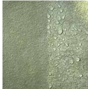
Prensip 2, yöntem 2.1 MasterProtect mineral esaslı yüzeylerde uygulanan silan esaslı hidrofobik empenye malzemelerdir.
